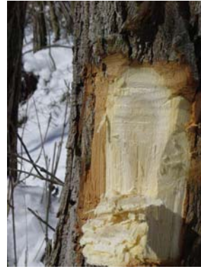
Abb. 2: Die Holzzonen sind bei der Robinie gut unterscheidbar - Rinde: dunkelbraun - Phloem: braun - Splintholz: gelb + weiß - Kernholz: hellbraun
